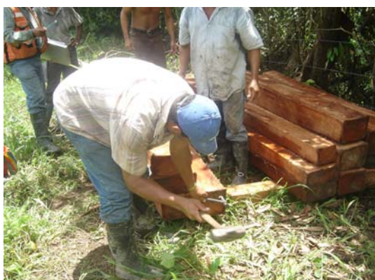
Imagen 1 Ilustra la marcación de la madera utilizando la marquilla diseñada para este fin.
